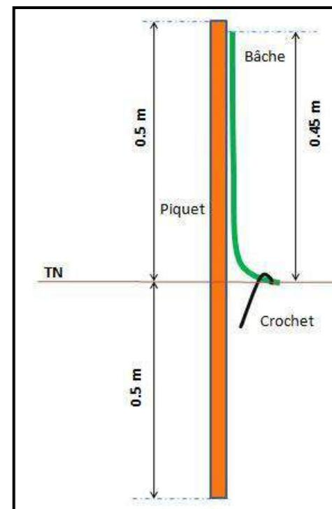
Figure 11 : Coupe de principe pour la pose de la bâche (Rainette)
