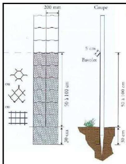
Figure 13 : Grillage à petite section de type 6 (SETRA, 2005)
